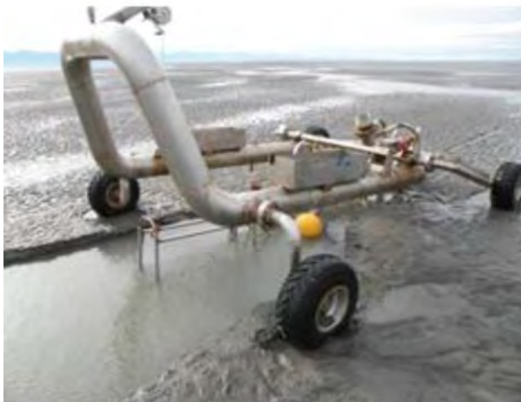
Foto 3 – Exemplo de carrinho de jateamento (jetting sledge)
